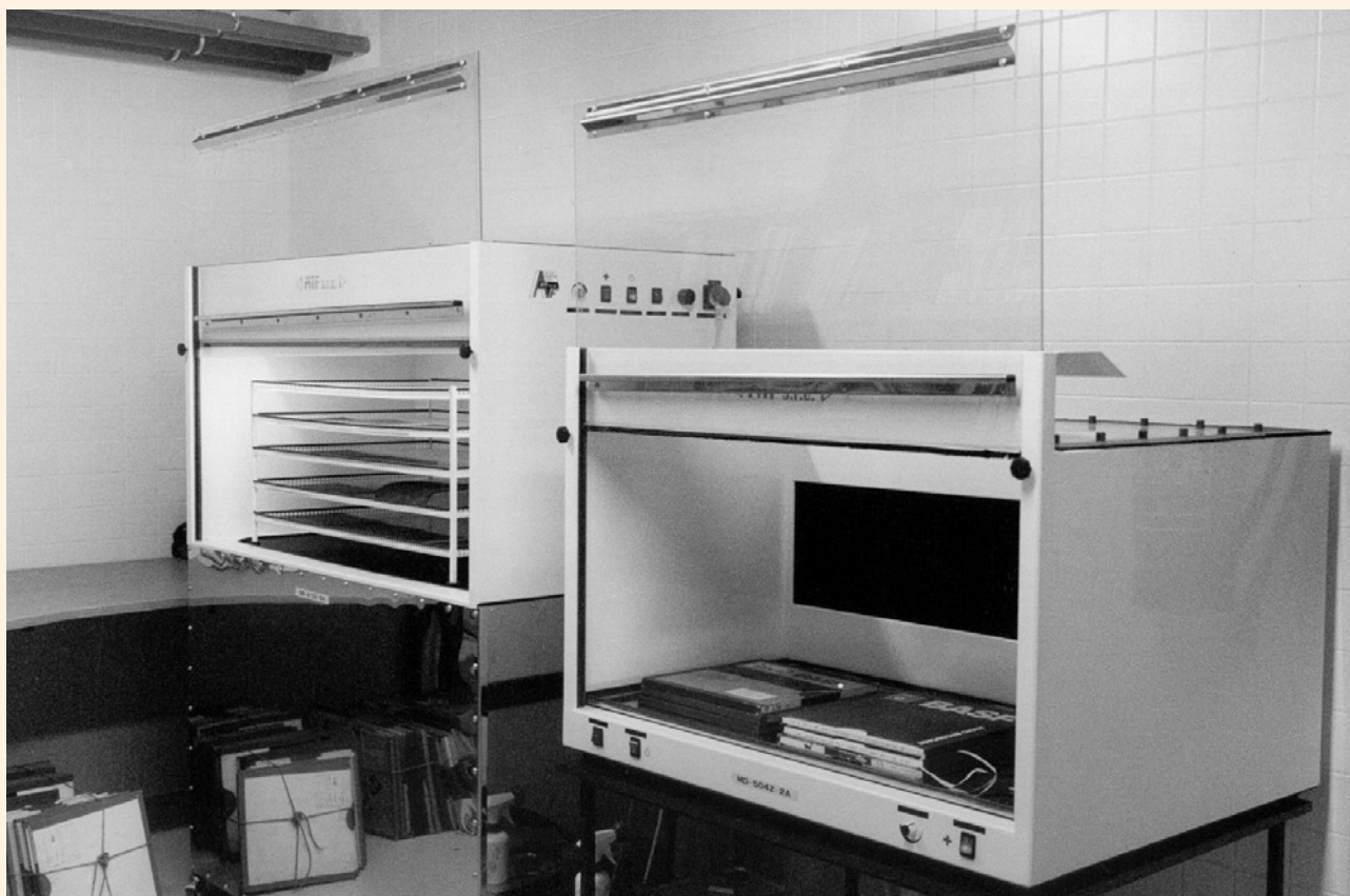
Dezinfekční komora pro mechanickou i chemickou očistu dokumentů
